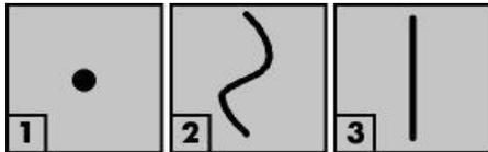
Rilasciare la pistola dopo l'applicazione per fermare lo scorrere dell'adesivo. Fare pressione per posizionare gli elementi da incollare. Se necessario (es. oggetti pesanti e in tensione) usare nastro adesivo, cunei o sostegni per fissare e sostenere gli elementi per le prime ore (almeno 24). È possibile riposizionare gli elementi dopo pochi minuti dall'applicazione. Poi premere nuovamente. Assicurare ventilazione (spazio minimo tra le superfici di 1 mm)
